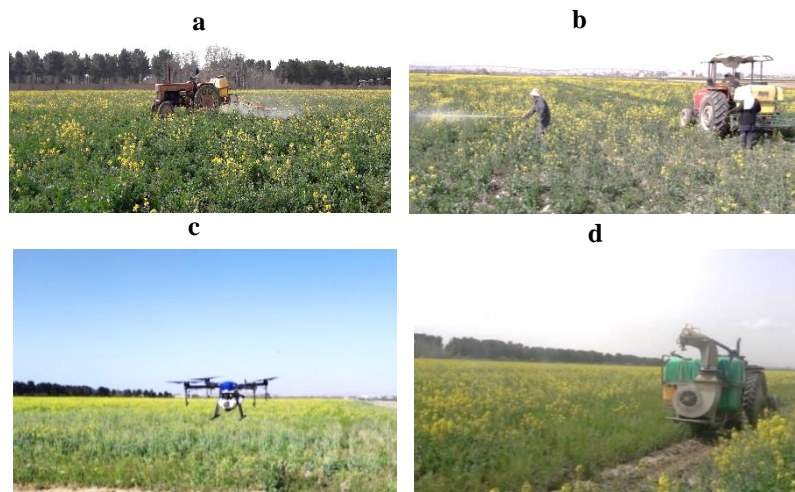
شکل ۱. چهار مدل سمپاشی آزمون‌شده: سمپاش بوم‌دار پشت‌تراکتوری (a)، سمپاش لانس‌دار پشت‌تراکتوری (b)، پهپاد سمپاش (c)، سمپاش توربینی (d).
