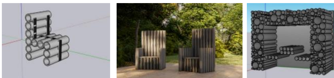
شکل ۵. ساخت نیمکت‌ها و نشیمنگاه‌ها از لوله‌های دورریز (ترسیم نگارنده)
